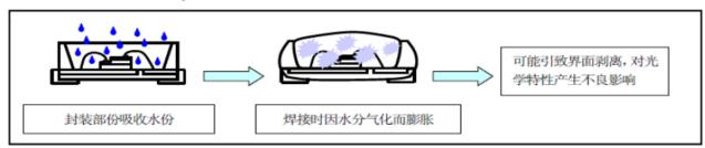
1. 本产品使用密封防潮抗静电袋包装,并附有干燥剂,未开封的产品有 2 个月的保存时间;当存储时间超过规定的 2 个月时需重新烘烤。
